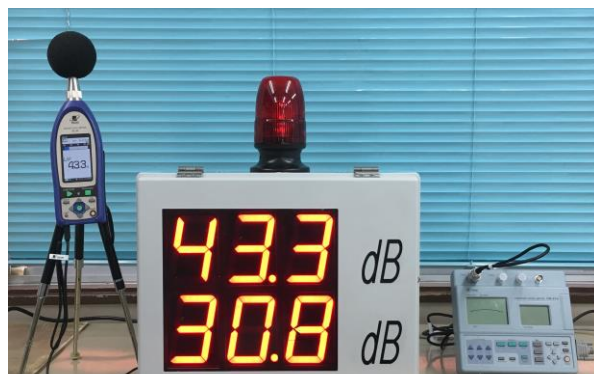
騒音計と振動レベル計は表示器内部に収納できます。
